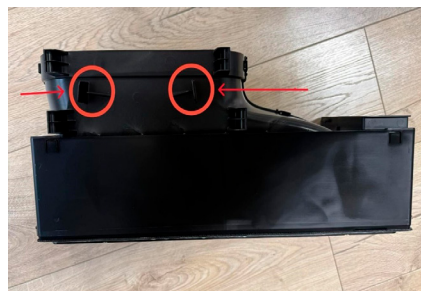
Sotto: il gruppo filtrante, in rosso sono evidenziate le due clip e dove esercitare la pressione per sganciarlo.
